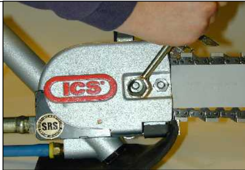
ETAPE 8: Maintenir toujours le nez du guide et serrer fermement les écrous du garde-chaîne. Voir Note 3.
